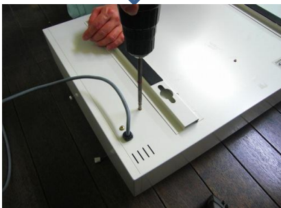
背面の3本の小さいネジを外します 右側
