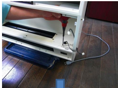
ファンユニットのネジを外します 右側
